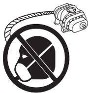
No utilizar el equipo adecuado de seguridad puede conllevar la muerte o lesiones graves por inhalación de aire comprimido. Consulte las normas de OSHA, y todos los códigos, normas y reglamentos federales, estatales y locales pertinentes que rijan el uso de equipos de seguridad.
